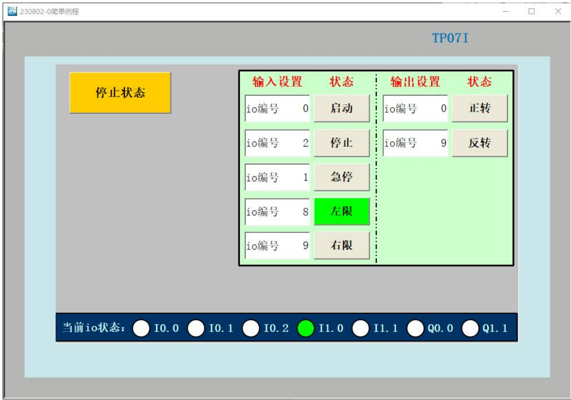
(编号 8 的 io 接通，映射到 PLC 中用于左限位)
