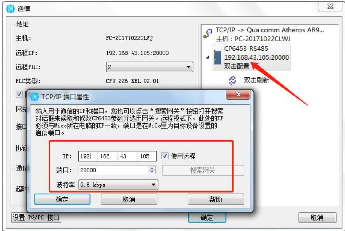
6453 远程 HMI 端参数配置：如下图（可支持西门子 S7-200PLC，通讯驱动程序选择 SIMATIC S7-200 即可）
